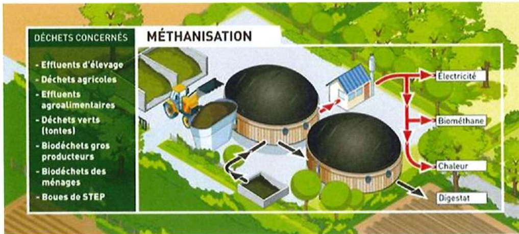
Synoptique de principe d'un site de méthanisation (doc. ADEME)
